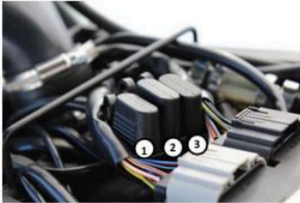
Poznámka: Barva tří vodičů ve svazku za pojistkami určuje barvu a polohu příslušných pojistek.
